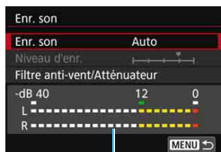
Compteur du niveau
